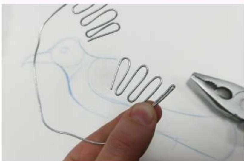
3. Плоскогубцами сжать петли так, чтобы получилась тонкая полоска. Чтобы в процессе петля не перекручивалась, надо придерживать её у основания пальцами.
